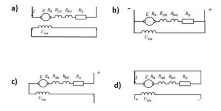
**5.** Укажите динамическую электромеханическую характеристику двигателя постоянного тока независимого возбуждения.
